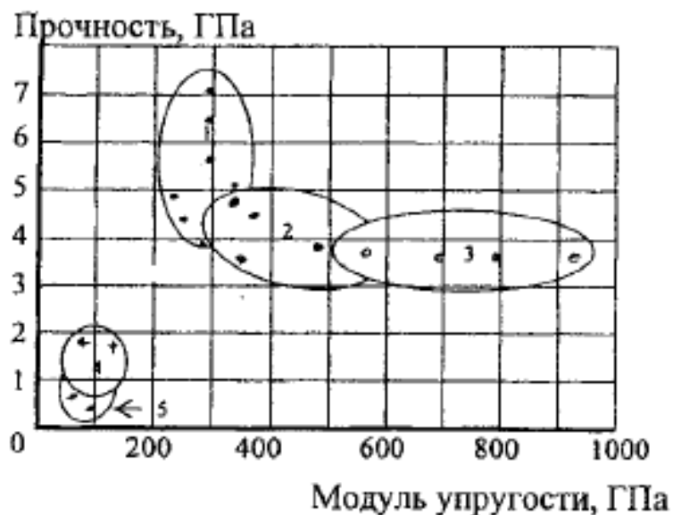
Рис. 1. Диаграмма упругопрочностных свойств углеродных волокон: 1-высокопрочные из полиакрилонитрила, 2- высокомодульные из полиакрилонитрила, 3-высокомодульные из мезофазного пека, 4-на основе вискозного волокна, 5-на основе изотропного пека
